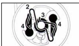
**2** = с помощью. Отвертки или подходящих щипцов отожмите осторожно от оси пружинный зажим.
