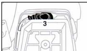
**3 = Штекер свечи зажигания снятите**
